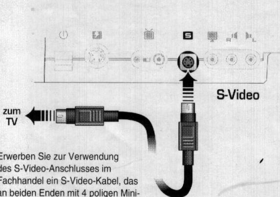
Erwerben Sie zur Verwendung des S-Video-Anschlusses im Fachhandel ein S-Video-Kabel, das an beiden Enden mit 4 poligen Mini-DIN-Steckern ausgestattet ist. Stecken Sie ein Ende des Kabels in die Buchse unterhalb des Piktogramms
