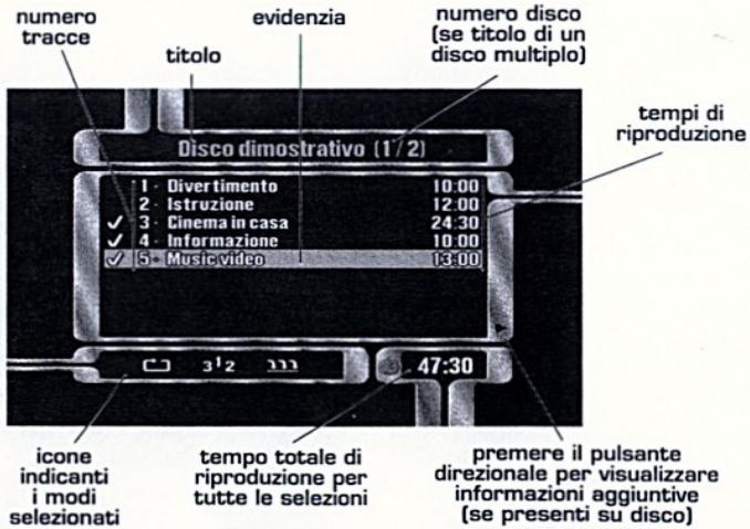
Per visualizzare le informazioni disco durante la riproduzione, premere Selezione. La visualizzazione dello stato appare in sovraimpressione, indica il numero traccia corrente, il tempo trascorso e rimanente per la traccia e il disco e le icone per i modi selezionati (ripeti, casuale o campiona).
